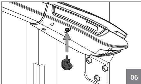
Coloque a chave de desbloqueio na ranhura sinalizada na imagem 05 (motor instalado à esquerda) ou 06 (motor instalado à direita).
