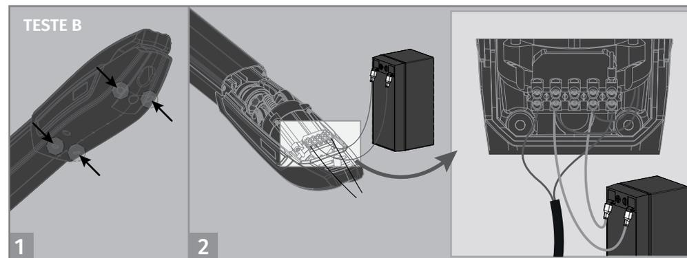
**Teste B** • Desaperte os 4 parafusos para retirar a tampa e aceder às ligações internas.
