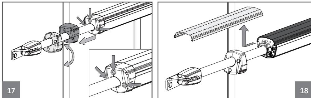
02 • Desaperte os 3 parafusos frontais, retire a tampa frontal e a tampa do perfil.
