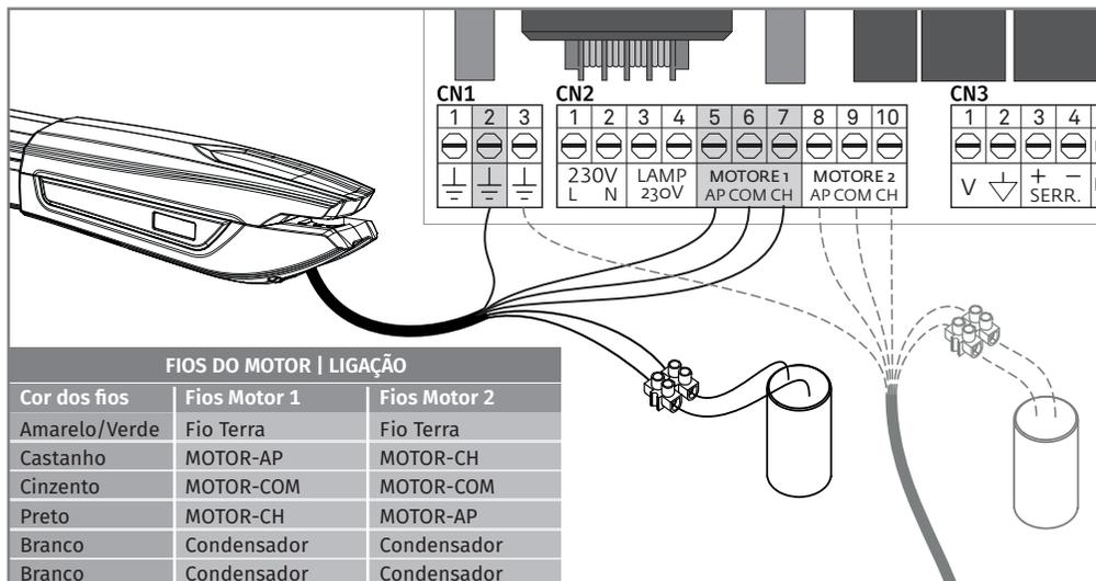
As ligações devem ser feitas como mostrado acima, ligando os 6 fios do motor nas entradas apropriadas da central e condensador.
