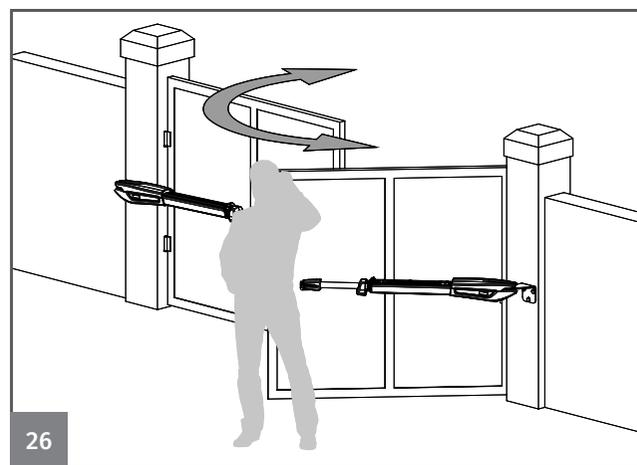
09 • Teste o portão manualmente e se necessário volte a ajustar os micros, como indicado nos pontos anteriores.
